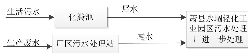
图 6.1-1 项目废水分类收集、分质处理流向示意图
